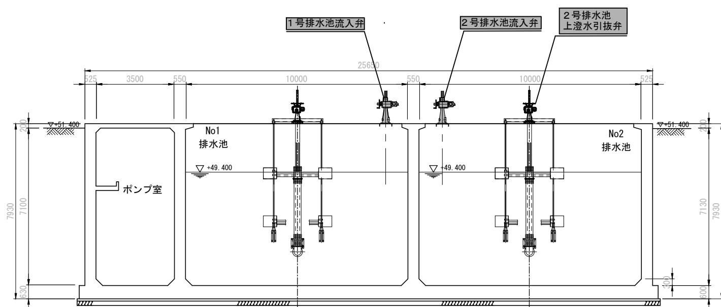
上澄水引抜弁設置図
