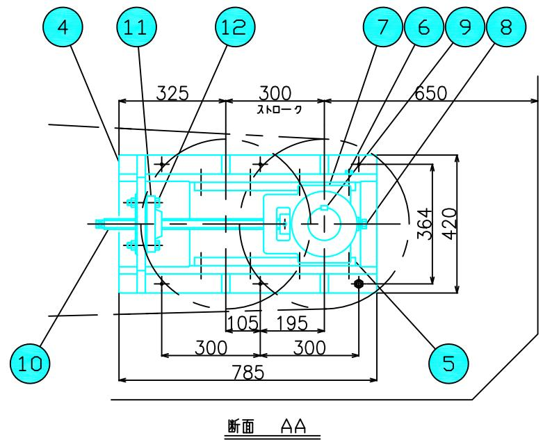
2系薬品沈澱池汚泥搔寄機テークアップ軸組立図
